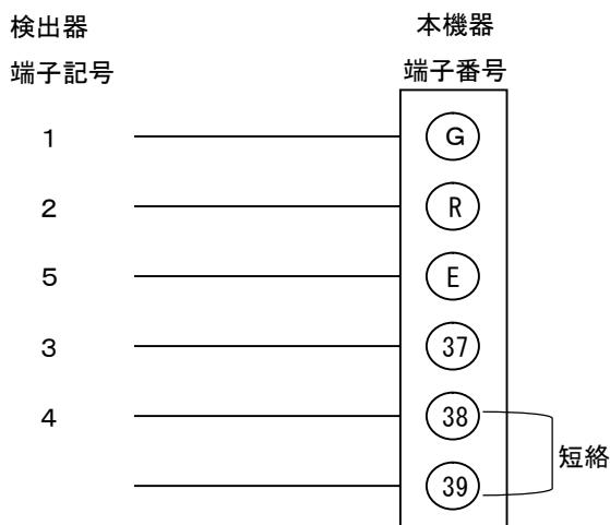
図 4.6 電極ケーブルを直接配線する場合
