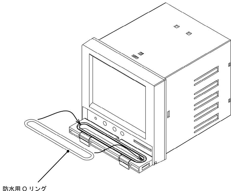
図 2.4 防水用Oリングの取り付け
