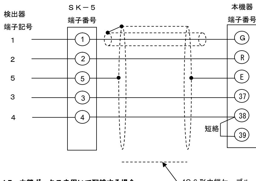
図 4.7 中継ボックスを用いて配線する場合
