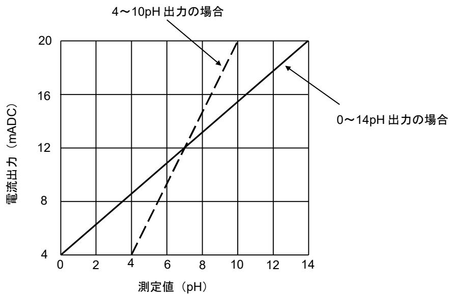
図 8.2 電流出力例
